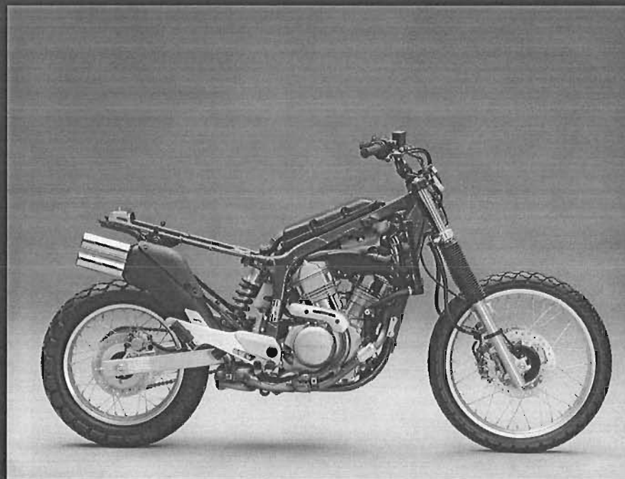
Le cadre reste proche de celui monté sur la 600 cm 3 mais avec toutefois des tubes de plus fort diamètre.
